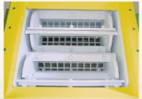
▲ وحدة التكسير الخاصة والتي يمكن عن طريقها التحكم فى جزيئات المادة المنتجة
