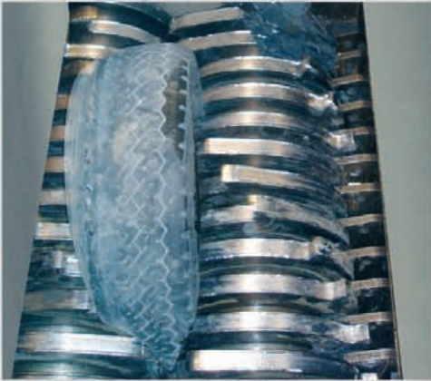
الصورة توضح ماكينة تقطيع الكاوتش المستعمل.
