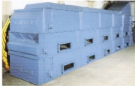
▲ الصورة توضح مبرد / مجفف كال في مصنع للسكر.
