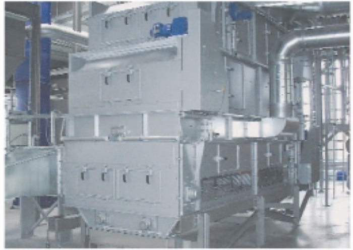
▲ الصورة توضح مجفف / مبرد كال في مصنع للصناعات الكيماوية.
