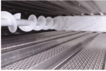
▲ توضيح الصورة منظر لوحدة سير الحصىرة والشقوق الموجودة بها.
