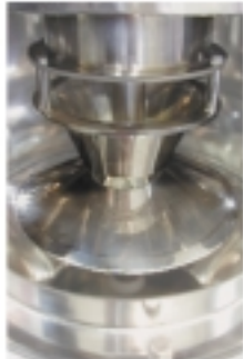
▲ الصورة توضح مخروط توزيع الخامات للرشاش الدوار
