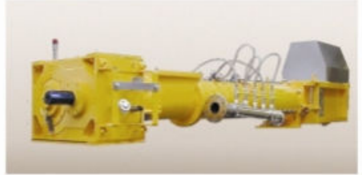
▲ الشكل يبين الاكسترودر كال طراز OEE (القياسى) والمجهز بخلاف خارجى لإجراء عمليات التسخين والتبريد الإضافية للمنتج.
